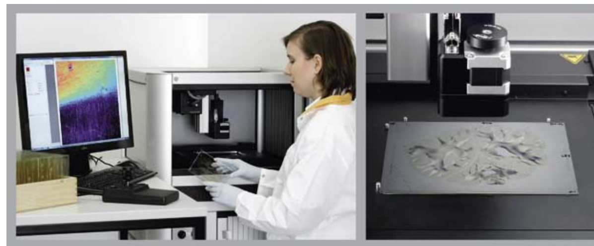
Това полуавтоматично четящо устройство разчита тримерната структура на тънките срезове от човешкия мозък, благодарение на свойството на миелина да създава псевдо стереообраз в поляризирана светлина
