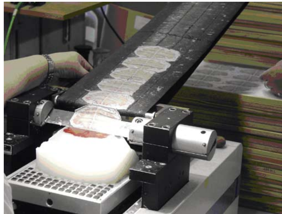
Мозъкът се разрязва на 7400 хистологични секции с дебелина 20 микрометра, които се ориентират един спрямо друг с точност не по-малка от един микро-
